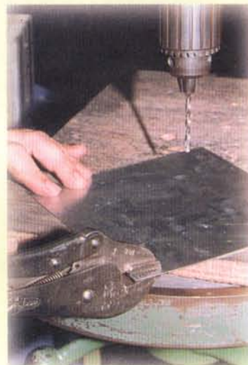
Figura 8.20. Forma de asegurar la lámina con una prensa para evitar accidentes en el proceso de taladrado
